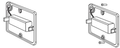
Der Hauptkörper wird mit der unteren Schale ausgestattet, um ihn zusammenzusetzen, und dann werden die Jimmy-Schrauben nacheinander auf der linken und rechten Seite verriegelt.
