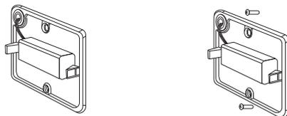
Alinee el cuerpo principal con la cubierta inferior para el montaje y, a continuación, apriete los tornillos de los lados izquierdo y derecho sucesivamente.
