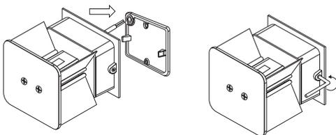
Coloque la cubierta de la lámpara y podrá empezar a utilizarla.
