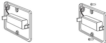
Le corps principal est équipé de la coque inférieure à assembler, puis verrouille les vis Jimmy sur les côtés gauche et droit à tour de rôle.
